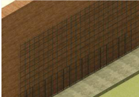
Fase 1: Montaggio dell'armatura in acciaio
